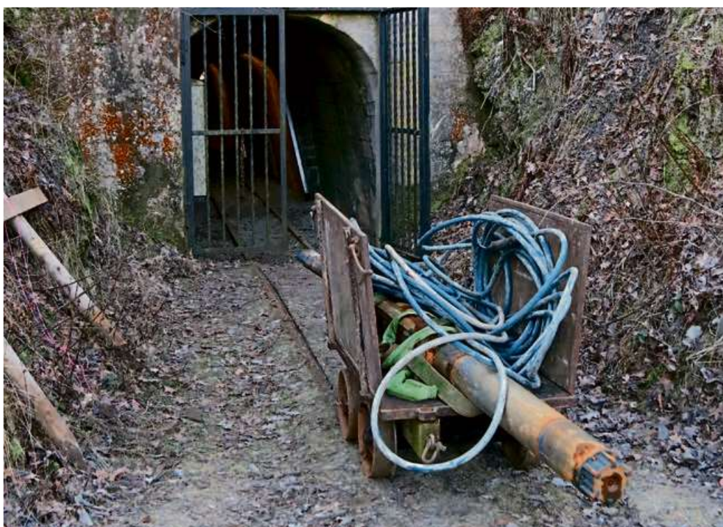
Beim Umbau in der „Constanze“ griff das Stadtwerke-Team auf alte Technik zurück: Unser Bild zeigt die alte Wasserpumpe mit Schlauch, die mit Hilfe einer alten Lore durch die Grube transportiert wurde.
