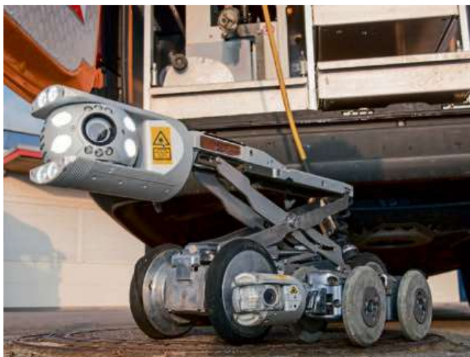
Mit dieser modernen Kamera werden die Kanäle untersucht. Foto: Augustin
