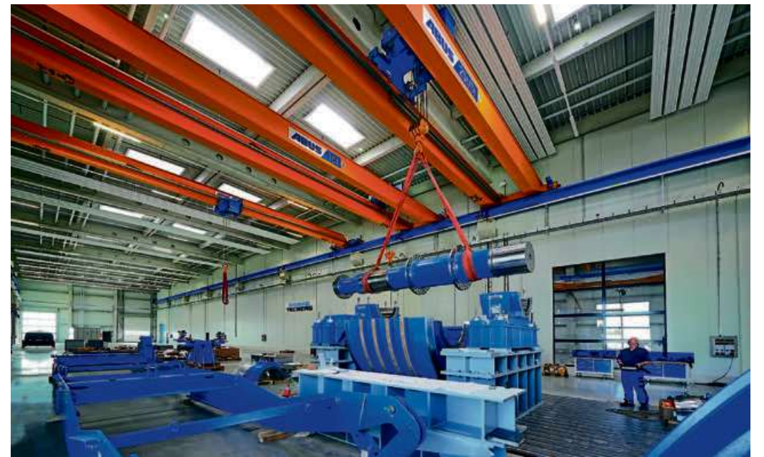
Aufbau einer Koepe-Fördermaschine auf dem Schwerlastprüffeld in der neuen Produktmontagehalle III der SIEMAG TECBERG. Foto: SIEMAG
