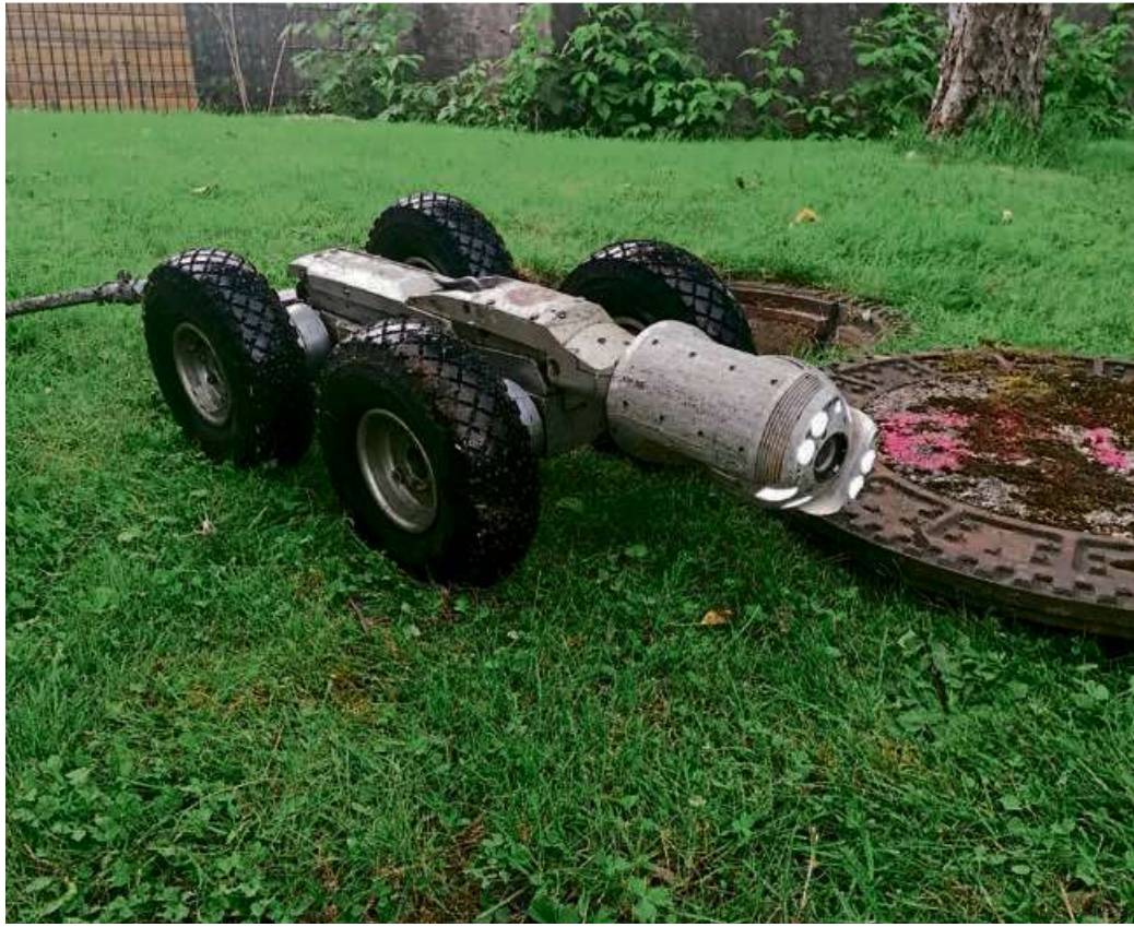
Mit diesen Spezialkameras werden die rund 200 Kilometer der Haigerer Kanalisation untersucht. Foto: Firma Schreiber
