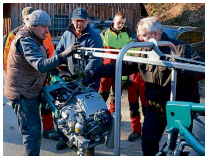
Die zugstarke Winde kann auch abmontiert und durch andere Zusatzgeräte ersetzt werden, die über eine Zapfwelle oder hydraulisch angetrieben werden. Foto: Ralf Triesch/Stadt Haiger
