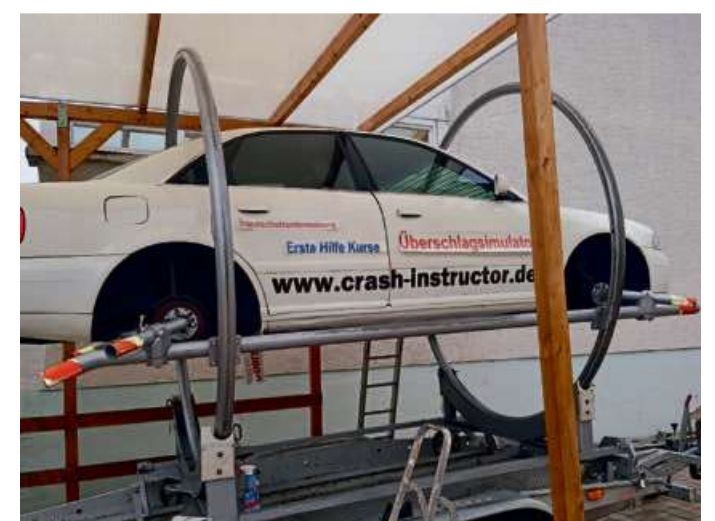
Dieses Gerät simuliert einen Überschlag im Pkw.
