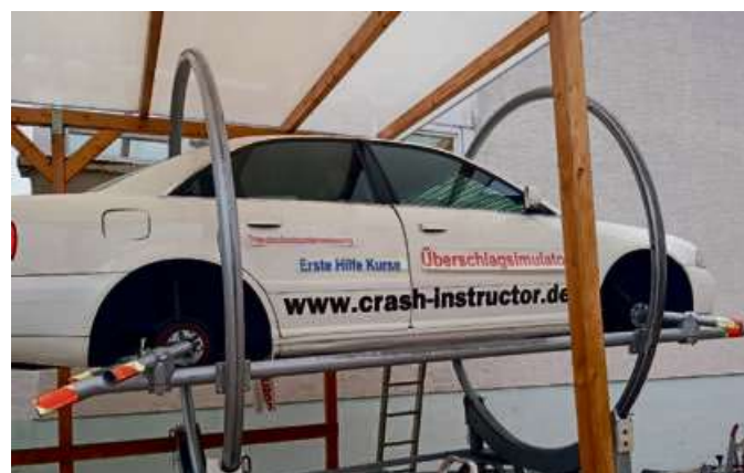
Dieses Gerät simuliert einen Überschlag im Pkw.
